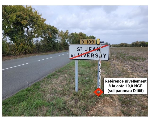
Vue de la référence de nivellement
